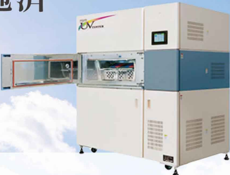
アイススーパーUVデスター（超促進耐候性試験）試験条件
